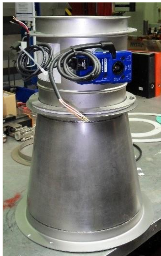
Vorfertigung Sonderbauteil für die Pulverindustrie Werkstoff: 1.4307
