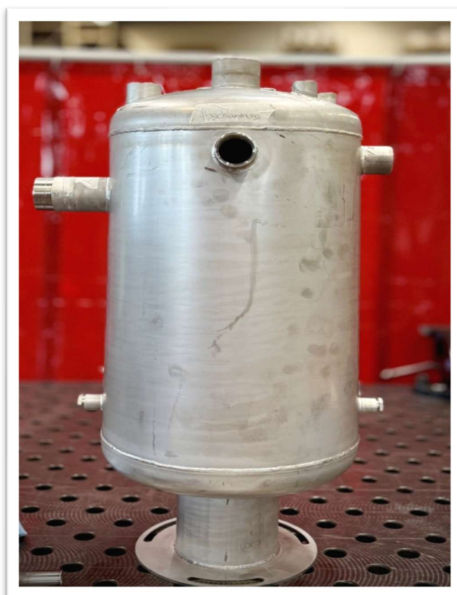
Druckluft Pufferspeicher, Betriebsdruck 16 bar, Werkstoff 1.4571
