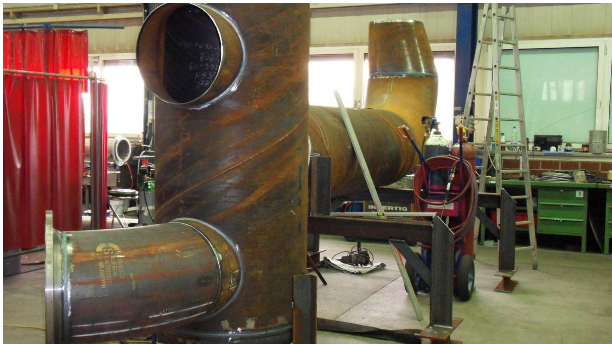
Anlagenbau XXL: Hier baute die Firma Lütkemüller eine hydraulische Weiche.© WP | Lütkemüller GmbH
