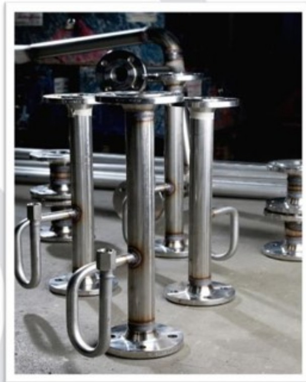
Bauteile für eine Dampfversorgung, Werkstoff: P235GH TC1
