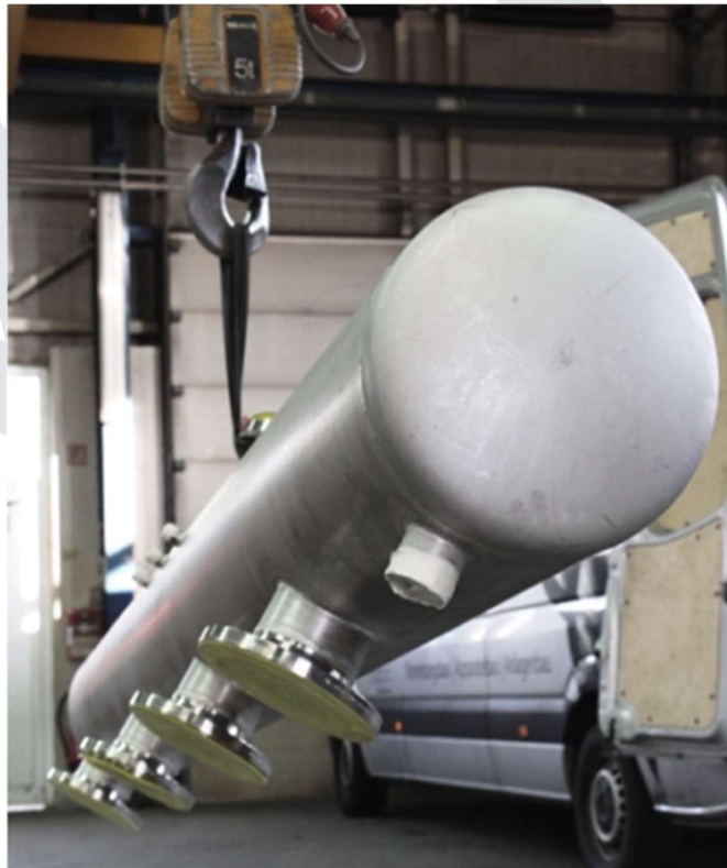
Hergestellter Druckluftverteiler DN250, Werkstoff 1.4571, inkl. Erstellung Konformitätserklärung, sowie Abnahme nach Druckgeräterichtlinie
