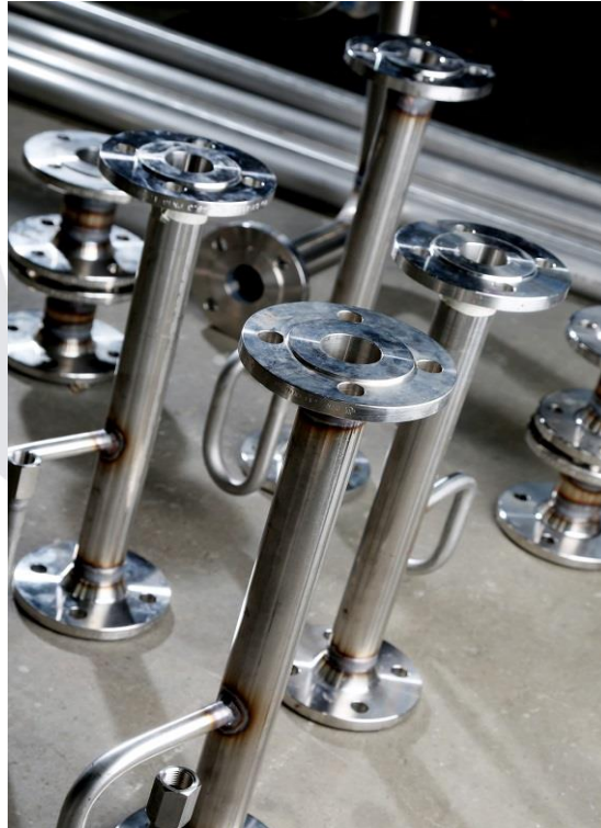
Anfertigung von Passstücken für eine Kühlwasserleitung, Werkstoff 1.4571
