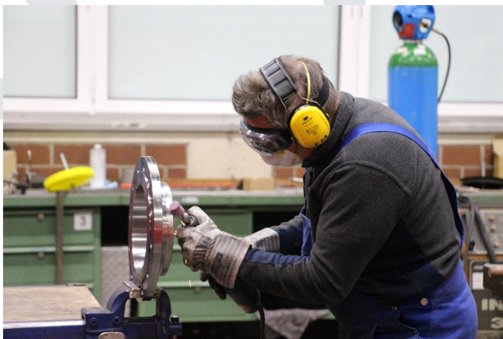
Rundnaht und Vorbereitung am Vorschweißflansch
