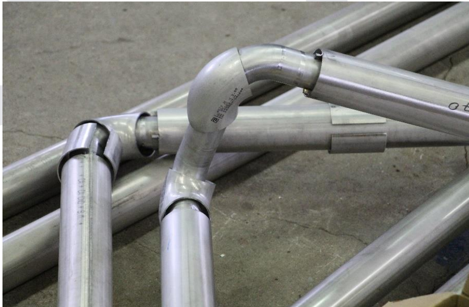
Vorfertigung Doppelrohrsystem, Werkstoff-Nr. 1.4571, DN32/DN50
