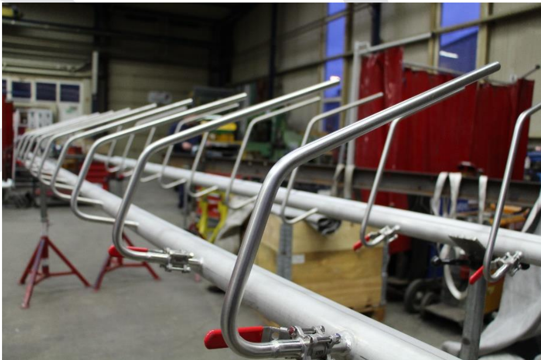
Leimauftragsrohr für die Papierindustrie, Werkstoff: 1.4571
