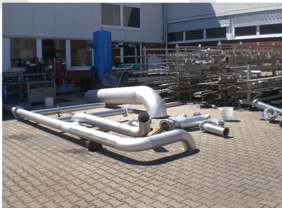
Vorgefertigte Rohrleitungen, Werkstoff 1.4571
