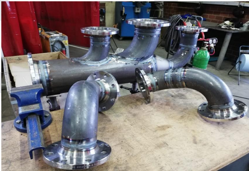
Verteilerrohr PN16 für Emulsion in der Stahlindustrie, Werkstoff: P235GH-TC1
