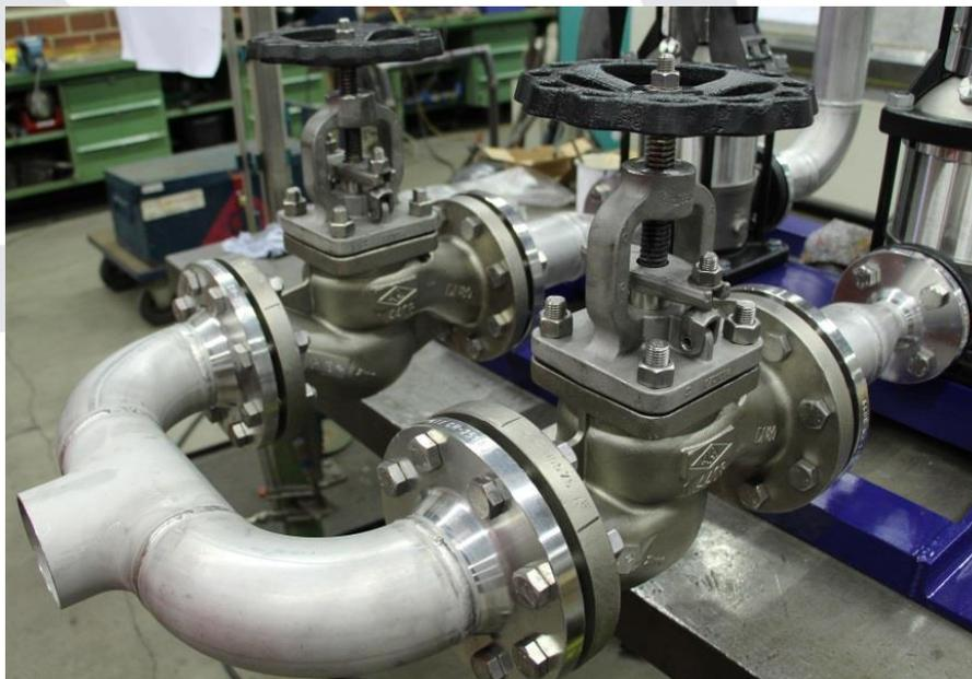
Vormontage Kondensathebestation, Werkstoff 1.4571
