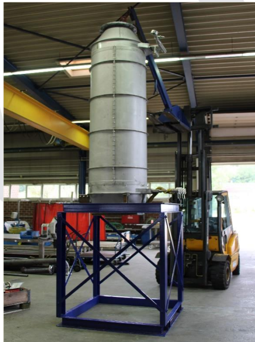
Projekt F + W Abgaswärmetauscher für eine ORC Anlage, Werkstoff: 1.4571
