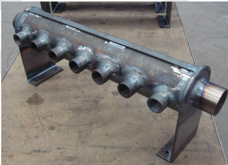
Kleinverteiler Heißwasserversorgung für Sonderanlagen Werkstoff: P 235 GHTC1
