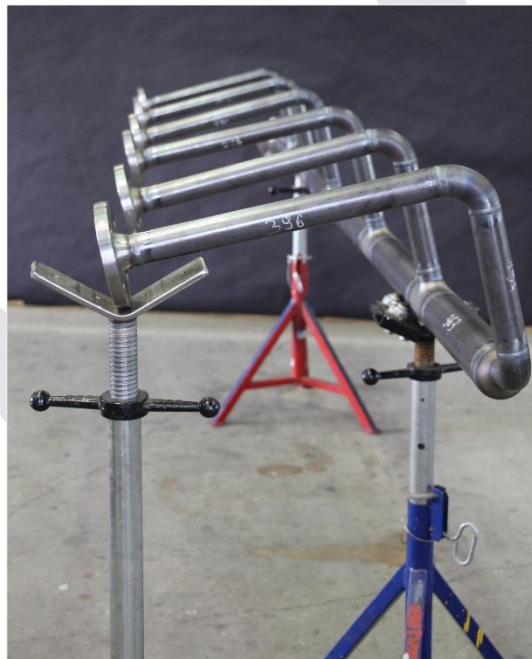
Vorfertigung Dampfverteiler für eine Klimakammer, Werkstoff: P235GH TC1
