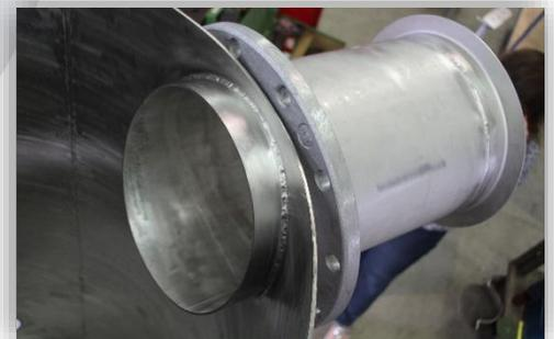
**Wasserabscheider DN900 mit Inneneinbauten für die Papierindustrie, Werkstoff: 1.4571**
