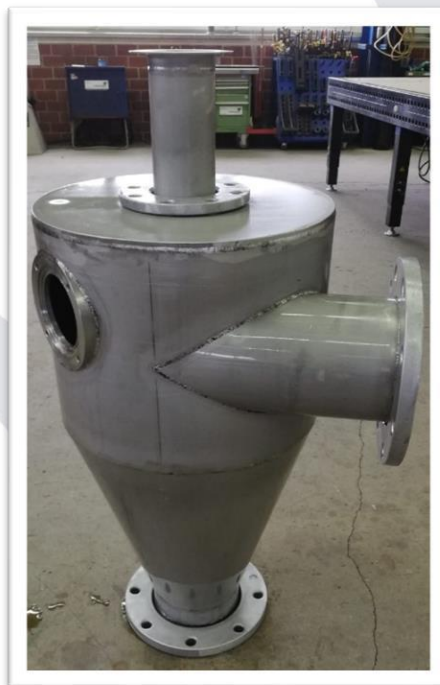
Wasserabscheider, Werkstoff 1.4571 für eine Vakuumanlage für die Papierindustrie
