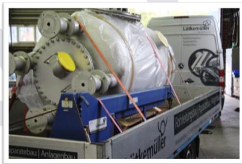
Abtransport eines gefertigten Behälters 1.4571 unter Berücksichtigung einer ordnungsgemäßen Ladungssicherung
