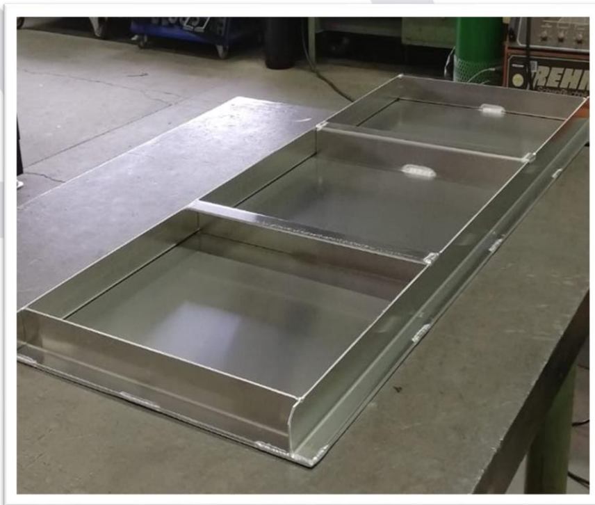
Teilstegment einer Abdeckung aus Aluminium ALMg3 (5,0mm) für die Holzindustrie
