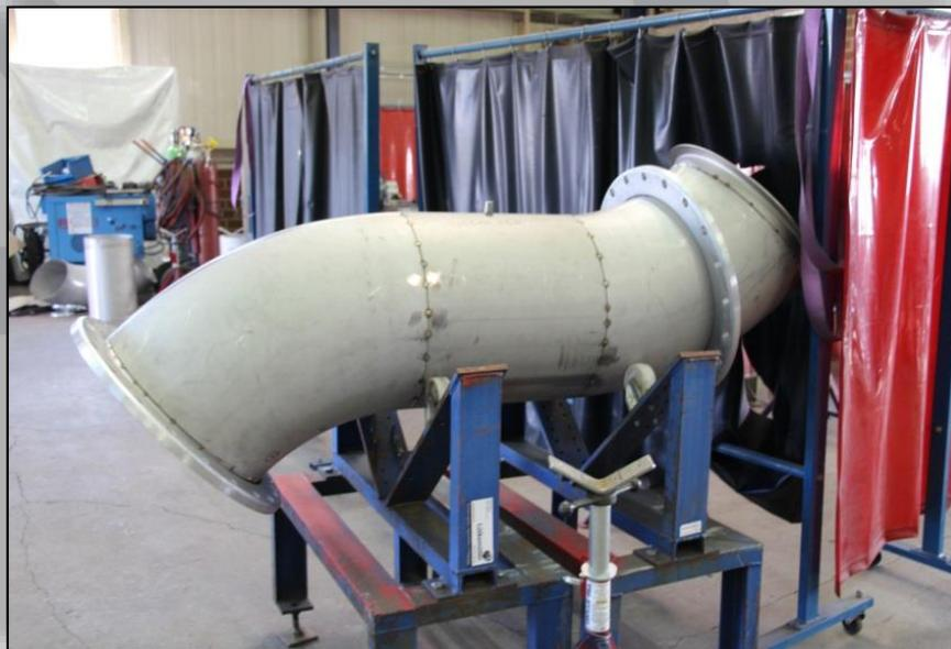
Vorfertigung Rücklaufrohrleitung DN600 PN10,
