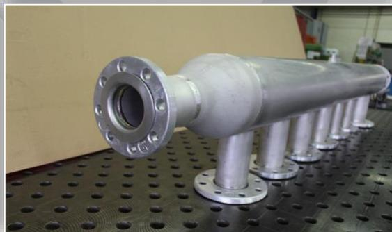
Druckluftverteiler DN200, Werkstoff: 1.4571/1.4404, 6 bar
