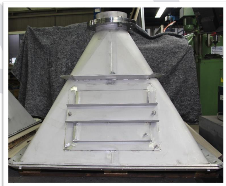
Auslauftrichter für die Lebensmittelindustrie , Werkstoff: 1.4307, rechteckig auf rund, DN200 PN10
