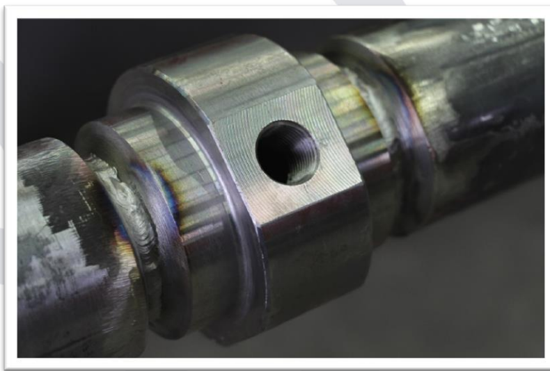
Vorfertigung Hydraulikrohr PN 320, 76,1x12,5 Werkstoff: S355J2H mit Messstutzen
